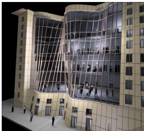
圖 9：Autodesk Revit Building 支援最精緻的幾何，並同時保有真實的建築專案描述。此處的帷幕牆由可列入明細表的豎框及玻璃帷幕板構成。
